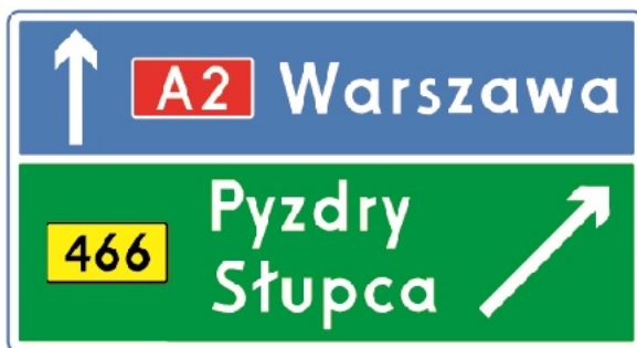
Rys. 6.3.2.5. Drogowskaz E-2c na autostradzie
