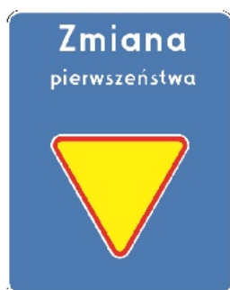
Rys. 5.2.54.2. Znak D-48 wskazujący wlot podporządkowany
