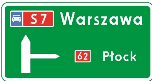
Rys. 6.3.1.7. Tablica E-1 na początku drogi ekspresowej
