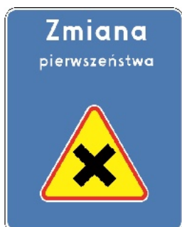
Rys. 5.2.54.1. Znak D-48 wskazujący skrzyżowanie dróg równorzędnych
